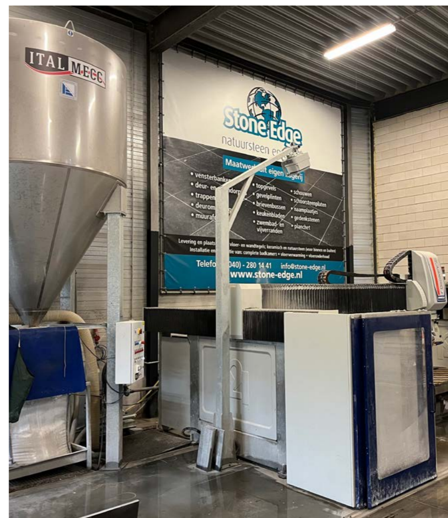
Een volautomatische EmmeDue Discovery 5 Axis Plus. Met zijn motor van 24 pk kan hij diktes tot 200 millimeter verwerken.
