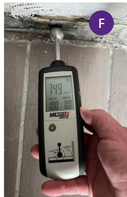
F Vocht meting onderaan waar de muur en vloer samenkomen ter vergelijking. We krijgen waarden tot 75%.
