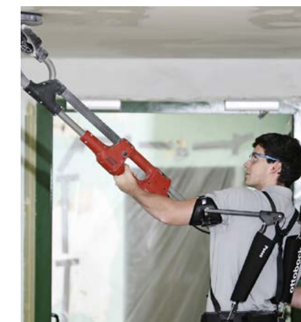
© Skelex - Exoskeletten nemen het gewicht van een specifiek deel van het lichaam weg en verdelen dat over een ander deel
