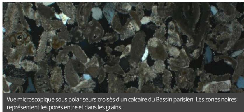
Vue microscopique sous polariseurs croisés d'un calcaire du Bassin parisien. Les zones noires représentent les pores entre et dans les grains.
